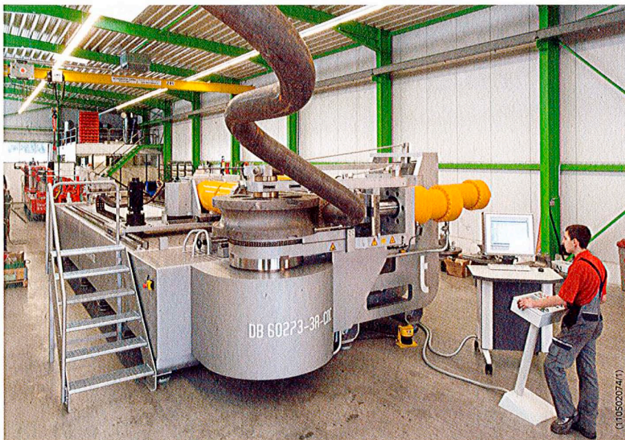
Mit der Kaltrohrbiegemaschine DB 60273-3A-CNC 3151 lassen sich hochlegierte Stahlrohre bis 300 mm Außendurchmesser bearbeiten (Foto: transfluid).
